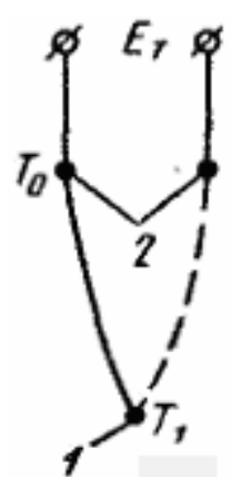
Рисунок 10 – Схема контура термопары
